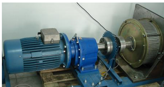
Fig. 2.42 Emulatorul de turbină de vânt utilizat la testarea în laborator a sistemului complet de conversie a energiei eoliene.
